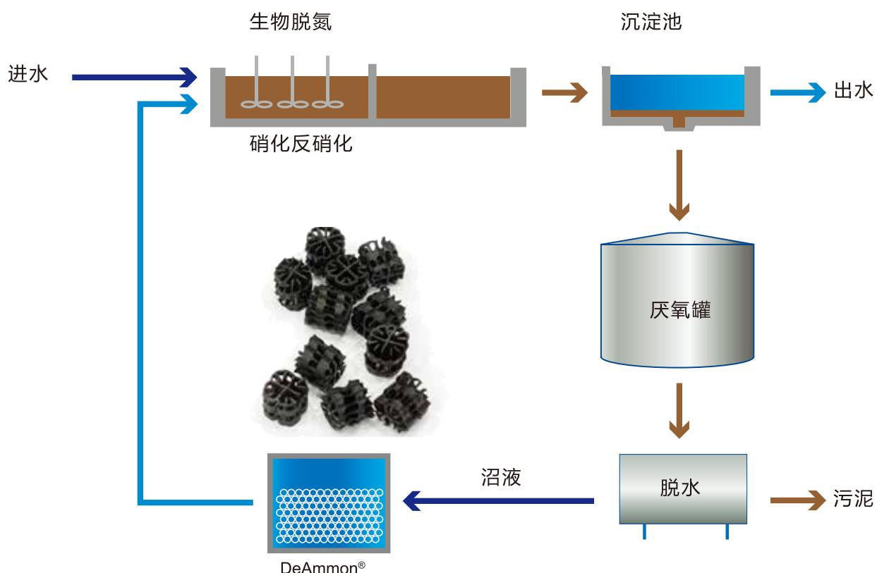
简化的脱氮废水处理方法。沼液提供了进水总氮负荷的15% ~ 30%。随着氮负荷的增加和更严格的排放标准，污水处理厂的氮循环是一个急需关注的问题。
